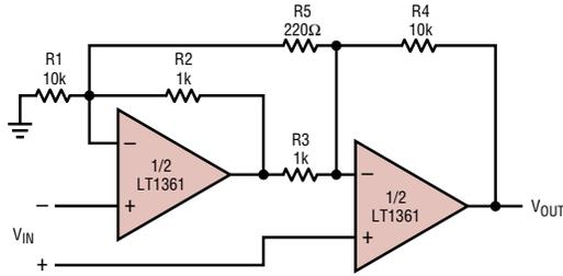
$$\text{GAIN} = \left[ \frac{R4}{R3} \right] \left[ 1 + \left( \frac{1}{2} \right) \left( \frac{R2 + R3}{R1 + R4} \right) + \frac{(R2 + R3)}{R5} \right] = 102$$
