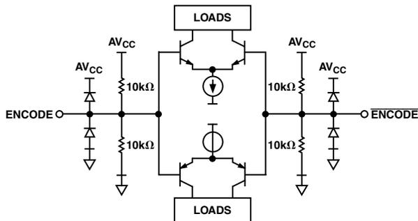
Figure 3. ENCODE Inputs
