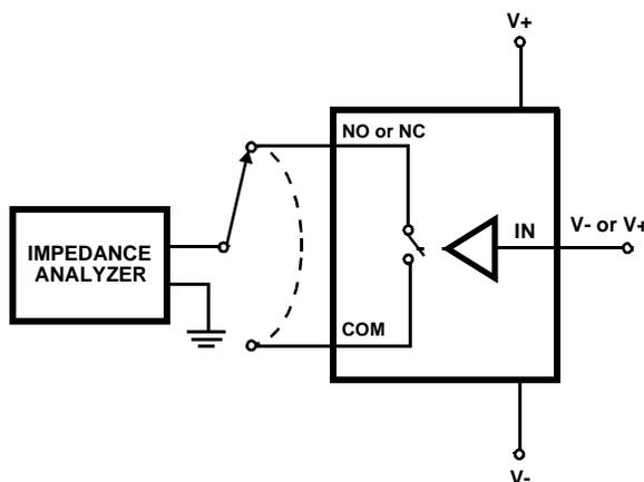
FIGURE 5. CAPACITANCE TEST CIRCUIT
