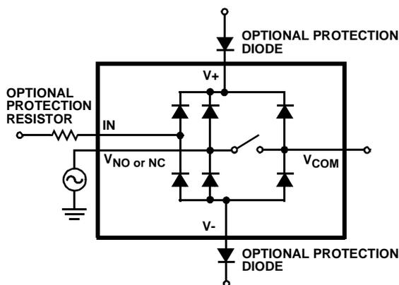
FIGURE 6. OVERVOLTAGE PROTECTION
