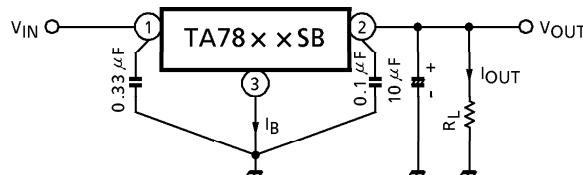
TEST CIRCUIT 2  $V_{NO}$
