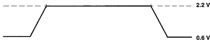
Figure 3. TTL-Level Inputs
