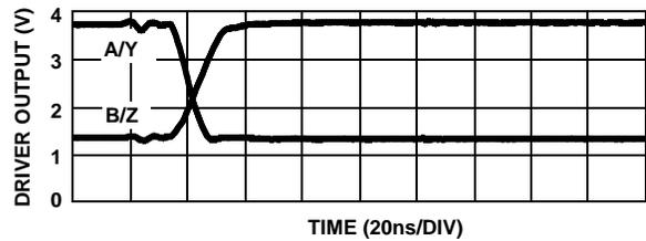
FIGURE 17. DRIVER AND RECEIVER WAVEFORMS, HIGH TO LOW (ISL81487)
