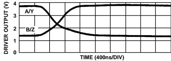
FIGURE 15. DRIVER AND RECEIVER WAVEFORMS, HIGH TO LOW (ISL8487, ISL81483)
