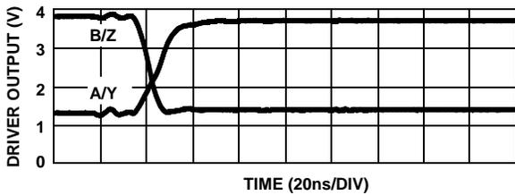
FIGURE 16. DRIVER AND RECEIVER WAVEFORMS, LOW TO HIGH (ISL81487)
