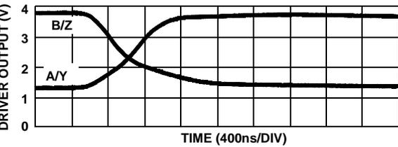
FIGURE 14. DRIVER AND RECEIVER WAVEFORMS, LOW TO HIGH (ISL8487, ISL81483)
