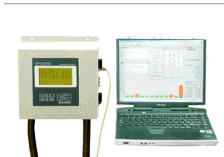
它还可以随时间测量显示商用电源、UPS、充电器电压和电流的实效值，并在发生 EVENT 时记录、分析瞬间波形，检查 UPS 之类的备用电源系统的运行状态的一种“智能型备用电源检测系统”。本产品符合 IEEE STD 技术标准，在备用电源或蓄电池的正常工作状态下，可 24 小时、365 日随时监控蓄电池单元的健全状态及输出曲线品质，而且不会给备用电池及蓄电池带来任何影响，是可靠的产品。
