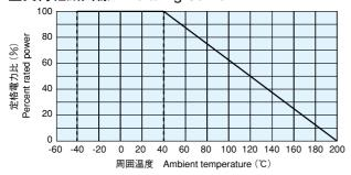
周囲温度40℃以上で使用される場合は、左図負荷軽減曲線に従って、定格 電力を軽減してご使用下さい。
