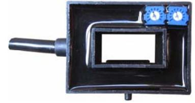
应用霍尔效应开环原理的电流传感器，能在电隔离条件下测量直流、交流、脉冲以及各种不规则波形的电流。
