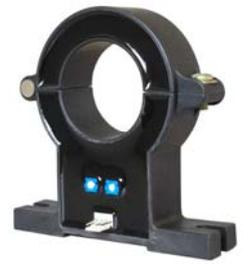
应用霍尔效应开环原理的电流传感器，能在电隔离条件下测量交流信号电流，转换成直流信号输出
