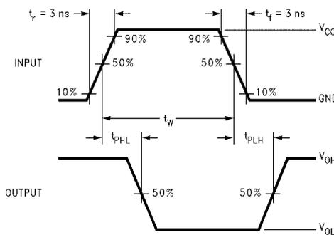
**FIGURE 3. AC Waveforms**
