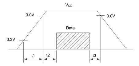
$V_{\text{CC}}\text{-dip conditions}$  : 3.4.2.
