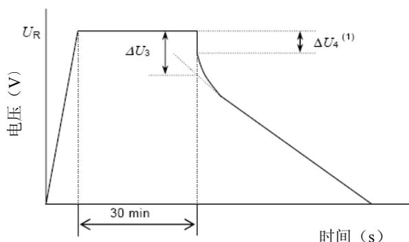
电压降不表示从放电开始点的连续降落电压  $\Delta U_4$ ，而是从曲线的直线部分作辅助线延长至与放电开始点交叉得到的  $\Delta U_4$ 。
