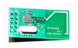
RF24L01B (PCB板载天线) (尺寸: 37mm\*18mm\*1.6mm)
