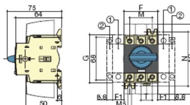
1. 一个分断开关主极(一个开关上最多加一个)或一个不分断中性极或一个保护接地极或一个辅助触点
