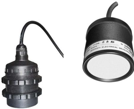
**RISEN-ES** 超声波物位/距离变送器是我公司专门开发的一款小空间安装检测的产品，它集超声波传感器、温度传感器、超声伺服电路、变送电路为一体，采用SMD贴片元件及自主研发的ASC专用芯片，使得整机电路非常紧凑、简洁，内部信号隔离输出更适合工况，出厂48小时高温及电老化，使其具有很高的稳定性和长期可靠性。外形精巧美观，防护级别最高可达IP68。在液体罐、墙面、运动臂或仪器壳体上固定变送器时，无须螺钉、改锥等工具，只要有一个圆孔或锣孔即可，使得安装非常快速稳妥，检修拆卸十分方便！
