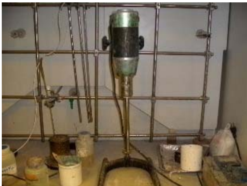
Photo 1. 主剂与硬化剂混合后，以小型均质分散机搅拌均匀。
