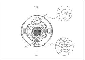
打开前盖,按图示调节延时、光敏度。对于延时旋钮(16-350 秒可调,也可根据客户要求订做调节范围),逆时针调节 TIME 为延时时间增长,反之,延时时间变短;对于光敏度调节,逆时针调节 LUX 光敏度减弱,反之,光敏度增强。
