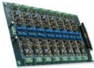
将16路mA、mV小信号调理为标准电压输出；低通滤波；输入：0~10mA，0~20mA，4~20mA，0~10mV，0~30mV，0~50mV，0~200mV，0~500mV；输出：0~5V，0~10V。
