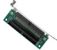
转接板，带挡片插入计算机，将板卡内侧一个50芯排线接头引出计算机
