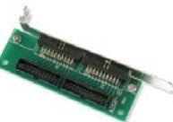
转接板，带挡片插入计算机，将板卡内侧两个20芯排线接头引出计算机
