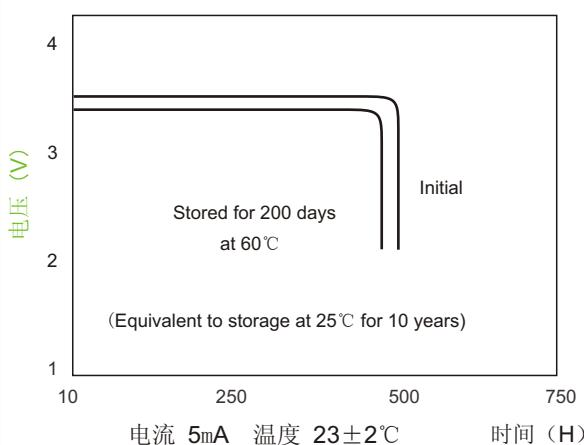
Load-Capacity Characteristics 容量\电流\温度关系特性
