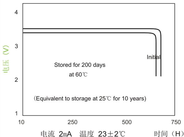
Load-Capacity Characteristics 容量\电流\温度关系特性
