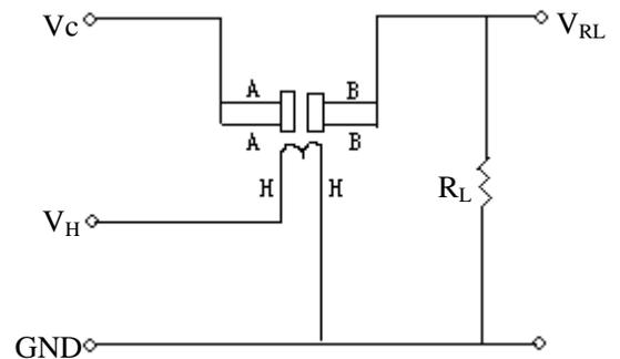
上图是传感器的基本测试电路。该传感器需要施加2个电压:加热器电压(V<sub>H</sub>)和测试电压(V<sub>C</sub>)。其中V<sub>H</sub>用于为传感器提供特定的工作温度。V<sub>C</sub>则是用于测定与传感器串联的负载电阻(R<sub>L</sub>)上的电压(V<sub>RL</sub>)。这种传感器具有轻微的极性,V<sub>C</sub>需用直流电源。在满足传感器电性能要求的前提下,V<sub>C</sub>和V<sub>H</sub>可以共用同一个电源电路。为更好利用传感器的性能,需要选择恰当的R<sub>L</sub>值。
