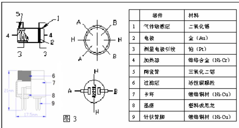
MQ-9 气敏元件的内部构造如图 3 所示，由微型  $Al_2O_3$  陶瓷管、 $SnO_2$  敏感层，测量电极和加热器构成的敏感元件固定在塑料或不锈钢制成的腔体内，为了改善传感器的选择性，传感器气室用活性炭过滤层与外界隔开。加热器为气敏元件提供了必要的工作条件。
