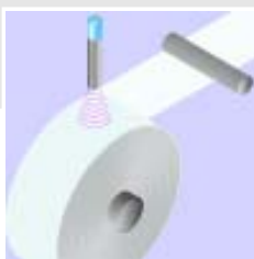
◀ 卷曲状态：卷曲物的直径测量
