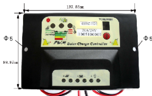
纵向坐标是外壳纵向的中心, 孔中心距离 127.75mm 镶嵌长方形开口尺寸 133.5*86 (mm)
