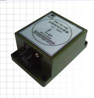
XW-TS1120/1130是双轴倾角传感器,通过测量重力加速度在其敏感轴上的分量,解算出传感器相对于水平面的倾斜角度。产品内置温度传感器,可提供传感器内部温度值及进行温度漂移的补偿。也可根据用户需求定制单轴倾角传感器或OEM产品。
