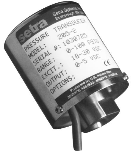
西特 (Setra) Model 205-2 是专为精确测量与不锈钢相容的气体或液体压力而设计的压力传感器。输出直流信号不需要另外附加信号与调节器，并且具有卓越的稳定性、高精度和快速动态响应等优良性能。可靠的电路，以及西特专利的可变电容传感技术，使Model 205-2结构设计简洁。一片17-4PH不锈钢膜片和一个绝缘电极组成了一个可变电容，随着压力增加，电容减少。Setra独特的电路检测电容的变化并将其转换成直流信号。
