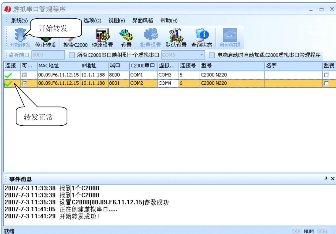
到此 TCP Server 模式的转发已完成，开启用户软件，选择相应的串口就可以进行通讯了。
