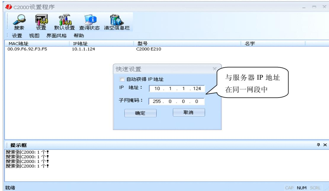
如果勾选“自动获得 IP 地址”，那么此 C2000 所在网段当中的 DHCP 服务器将为其自动分配 IP 地址；否则，需要人为指定 IP 地址。C2000 被默认设置为“**TCP Client**”方式，服务器 IP 默认为**本机 IP**，其他参数也均为**默认**，到此已经完成了设置。
