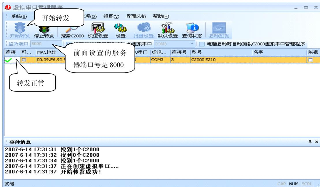
监听端口只有与服务器端口（在串口参数设置里面）匹配了才能正常转发，否则会失败。到此TCP Client 模式的转发已经完成，开启用户软件，选择相应的串口就可以进行通讯了。
