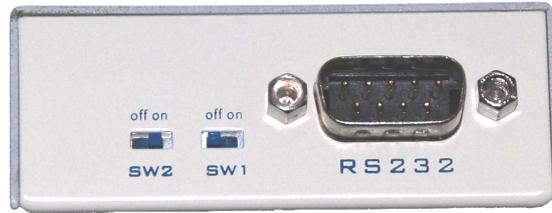
**SW1:** 通过将 SW1 拨到 ON，可以强制转换器使用默认网络设置进行工作，此时转换器的 IP 地址默认为 10.1.1.10，设置密码**失效**，同时转换器工作在 TCP 客户端方式，并向数据服务器 10.1.1.1 的 8000 端口请求建立 TCP 连接。设置完成后，一定要把 SW1 拨到 OFF 设置才能生效，此时，转换器进入工作状态。（**出厂默认设置为 OFF**）
