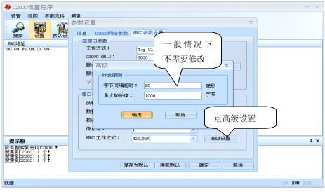
字节间隔超时: C2000 从串口收到字节后,在"字节间隔超时"过后,还没有从串口收到下一个字节, C2000 将收到的数据发送到网络上,推荐修改范围为 0~100ms。。
