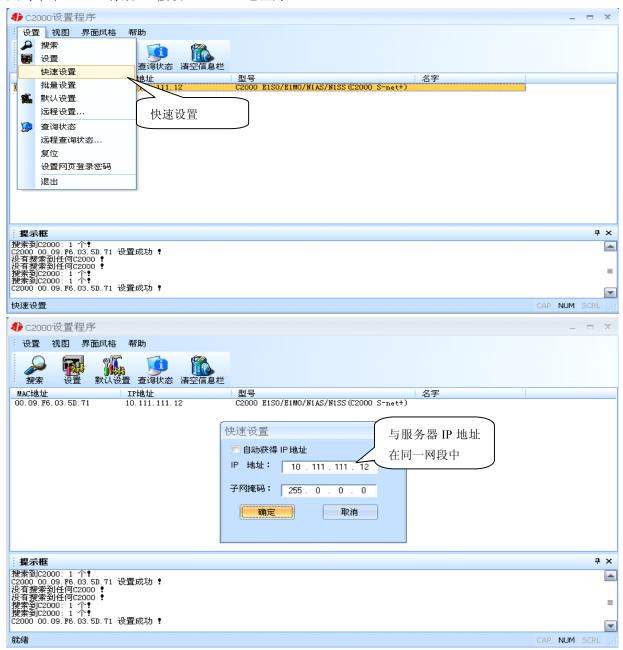
如果勾选"自动获得 IP 地址",那么此 C2000 所在网段当中的 DHCP 服务器将为其自动分配 IP 地址;否则,需要人为指定 IP 地址。C2000 被默认设置为"**TCP Client**"方式,服务器 IP 默认为**本 机 IP**,其他参数也均为**默认**,到此已经完成了设置。
