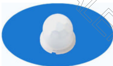
型号：8308-4 焦距：6 角度：60° 距离：5m 尺寸：210
