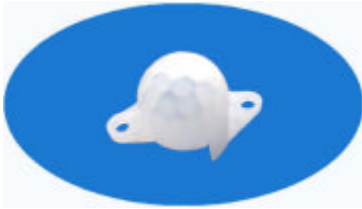
型号：8134 焦距：7.5 角度：90° 距离：6m 尺寸：14.8
