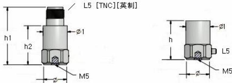
安装时传感器安装面应与被测件振轴垂直，安装表面要平整清洁（不平度应小于 0.01mm），为改善传感器和被测件耦合，可涂些清洁硅脂。
