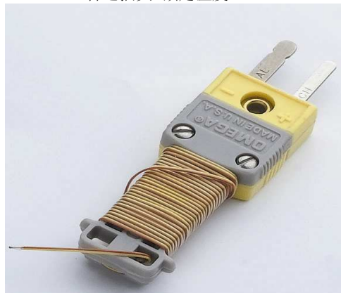
K-NOR-S-TT-36-36 K=K 型 NOR=尾柄 S=插头 TT=线材质特氟龙 36=线径 0.127mm 36=线长度 0.92M
