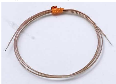
TT-K-36-18 TT=线材质特氟龙 K=K 型 36=线径 0.127mm 18=线长度 0.46M
