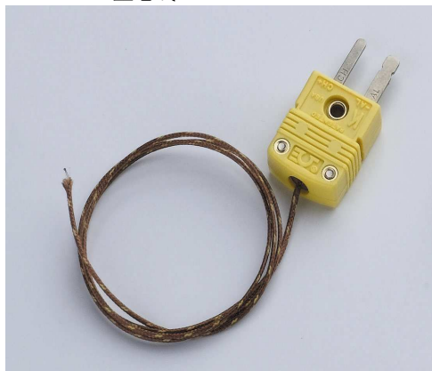
K-SM-GG-30-18 K=K 型 SM=插头 GG=线材质玻璃纤维 30=线径 0.254mm 18=线长度 0.46M
