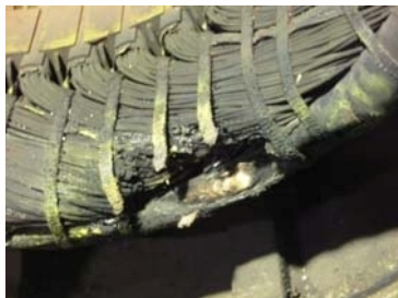
图1 变频器的PWM电压损伤电机的定子和轴承
