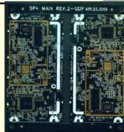
No. 3 : 6/L IMG PCB 6层沉金板
