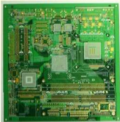
No. 4 : 10/L IMG PCB 10层沉金板
