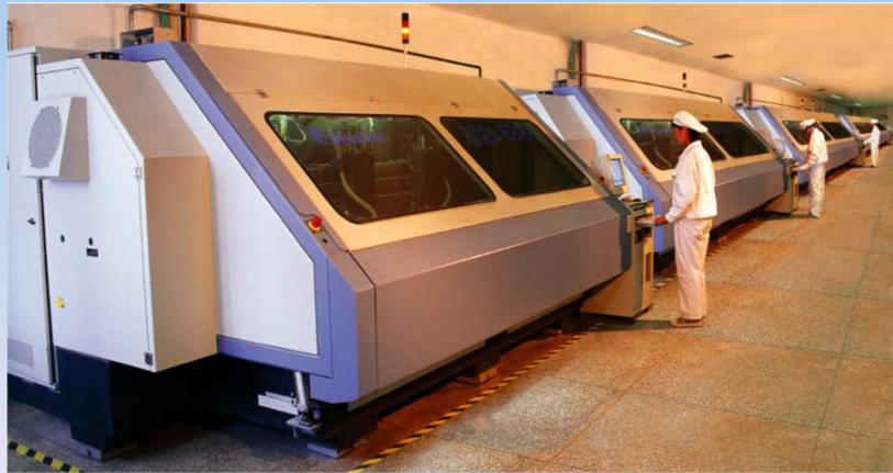
意大利 PLURITEC数控钻孔机 Italy PLURITEC NC Drilling Machine
