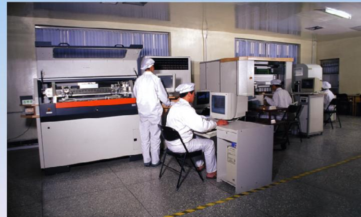
德国ATG飞针测试机、德国MANIA通用测试机器 Atg Fixtureless Moving Probe Electrical Tester cMania Universal Electrical Tester
