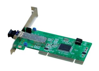
HNC-1300 系列, SFP 双纤传输; 百 兆速率; 传输介质: 塑料光纤, MM/SM 石英光纤; 传输距离可选。
