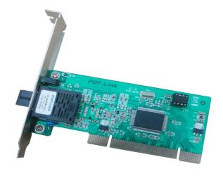
HNC-1400 系列, 1X9 单纤传输; 百 兆速率; 传输介质: MM/SM 石英光 纤; 传输距离可选。
