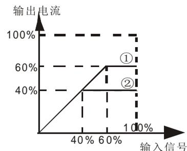
使用恒流功能时，拨码开关 SW1-1 拨向 ON 状态。这时限流功能须从输入信号进行限制。
