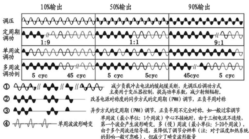
调压控制时，采用移相触发来改变可控硅的导通角，从而改变负载的电压有效值；如上图中调压方式波形图，在 10%时负载电压有效值是额定电压有效值的 10%。
