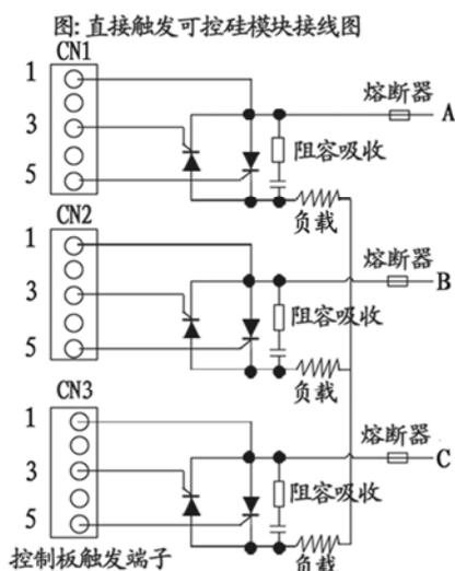
图 2-2 控制板与可控硅接线方式
