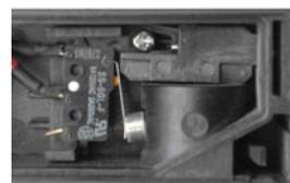
图3 接线盒内部构造图
