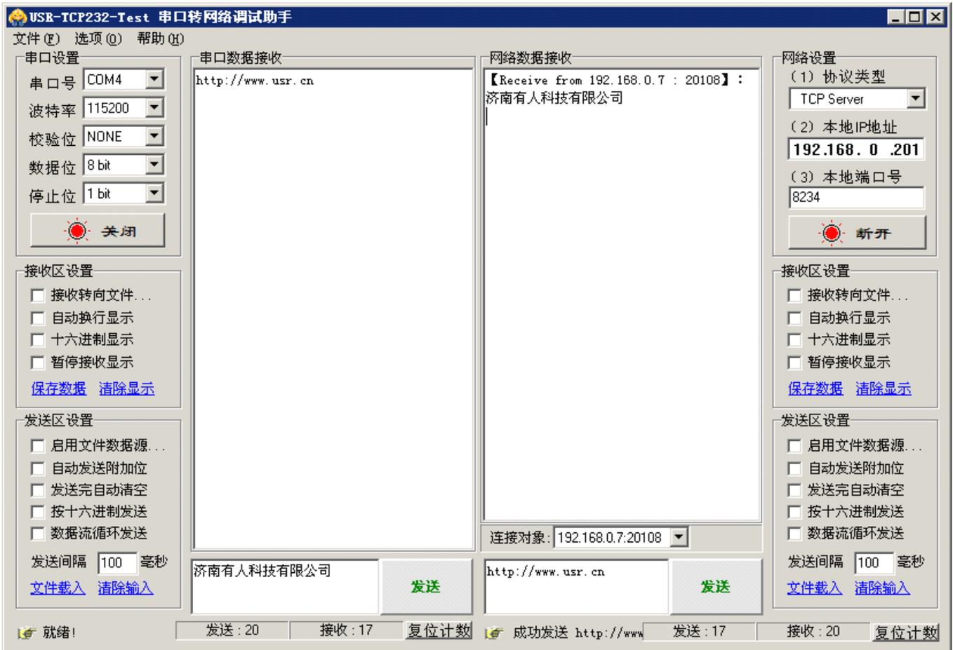
6、由于模块设置了 TCP Client 工作模式，会自动连接这个端口，很快你会看到，有设备连接到端口上，选择该发送目标（如上图中的 192.168.0.7:20108），输入要发送的内容，点击发送数据，就可以将数据发到模块的网络端，并从串口输出。
