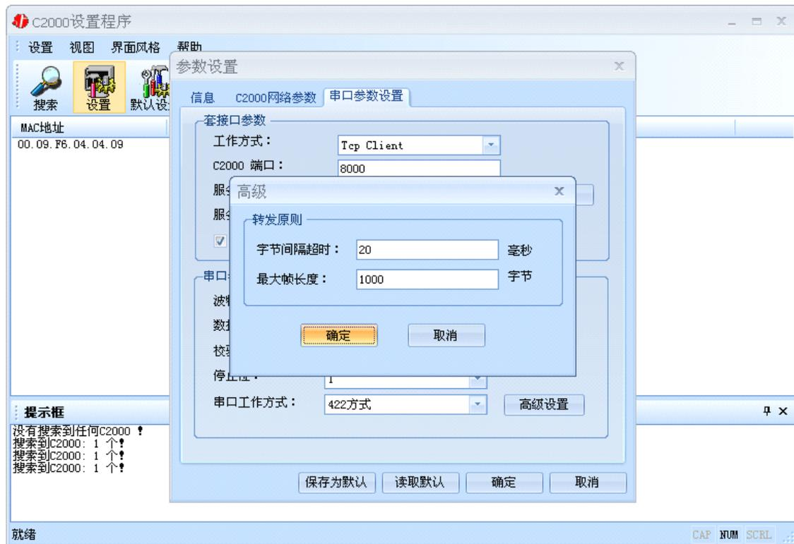
**字节间隔超时：**C2000 从串口收到字节后，在“字节间隔超时”过后，还没有从串口收到下一个字节，C2000 将收到的数据发送到网络上，推荐修改范围为 0~100ms。
