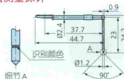
12AAC736 (2 \mu m)*1 12AAB408 (5 \mu m) 12AAB420 (10 \mu m) ( ): 针尖半径
