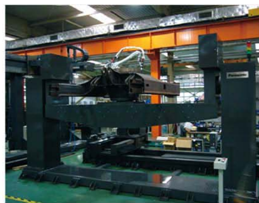
下底座焊接机器人系统
