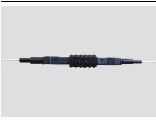
8. 打开制具两端压片，拿下冷接子，接续完成。
