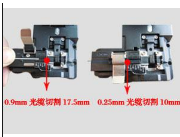
3. 开剥光缆后清洁并检验光纤，切割光纤。
