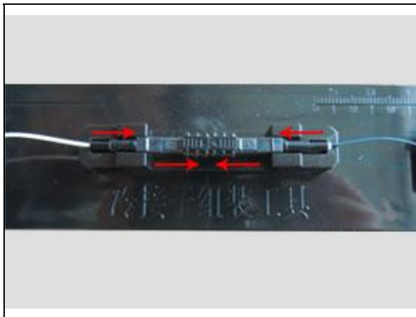
7. 分别将锁紧套和锁紧管推至最中央。
