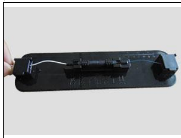
6. 将 0.9mm 光缆推向中间至光缆产生弯曲。
