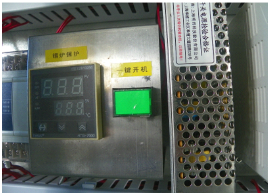
锡炉双温度控制保护，相位保护，（触摸式标配） 一键式启动，无需担心
