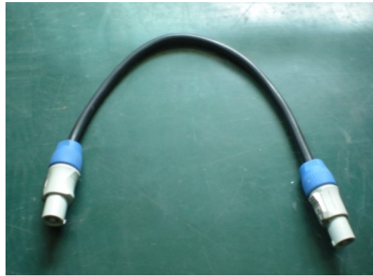
单元箱体之间的电源线
