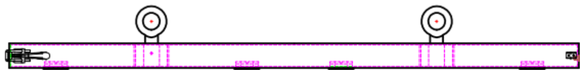
图9 一吊二吊梁与箱体连接示意图
