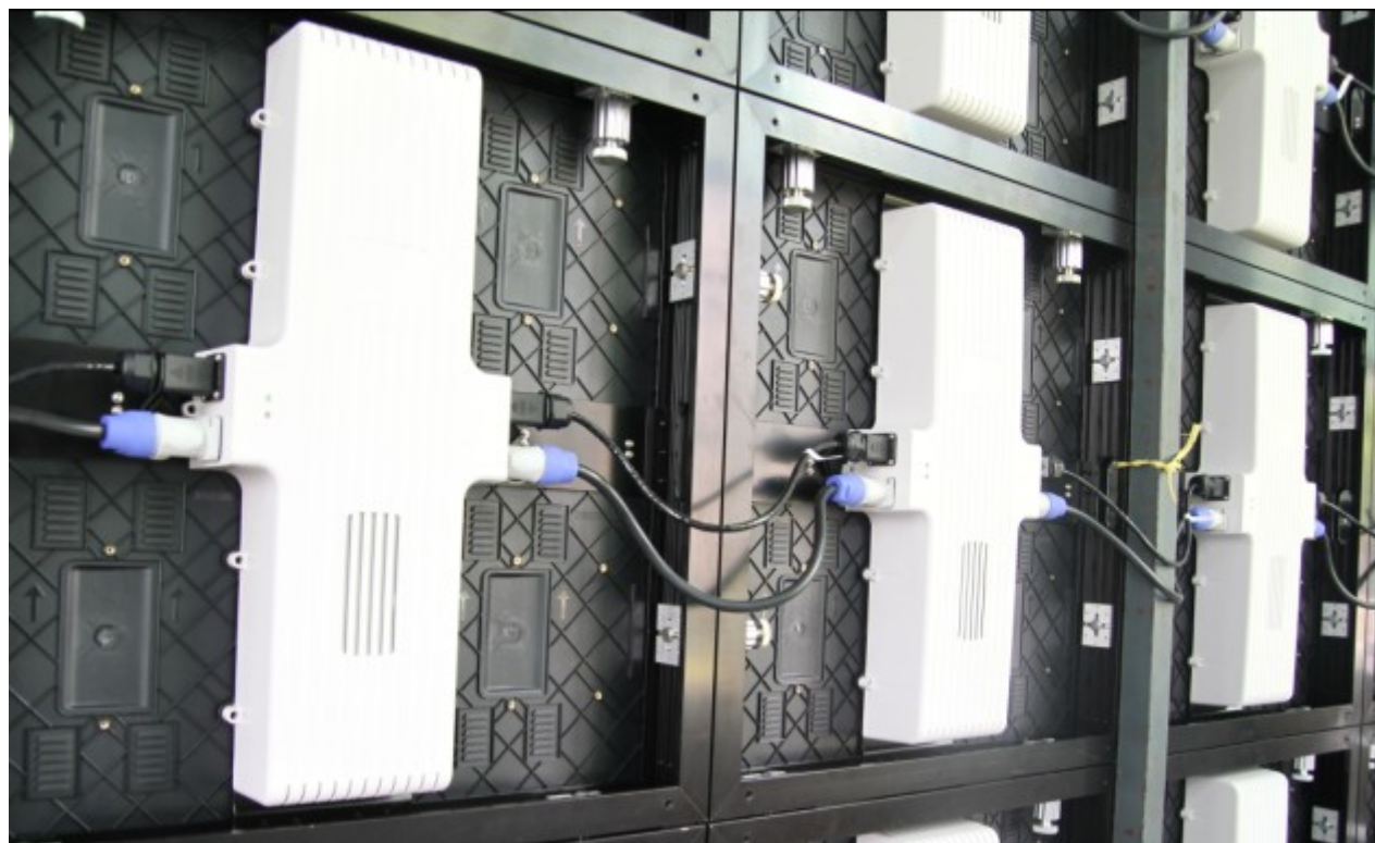
图15 单元箱体之间的电源线和信号线连接示意图
