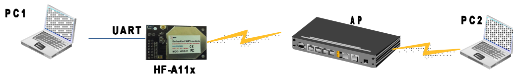
图-28 STA 接口连接调试
