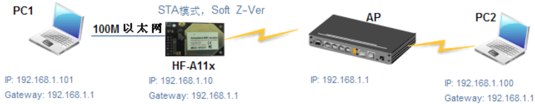
图-20 HF-A11x 以太网接口功能 (STA Z-Ver)
