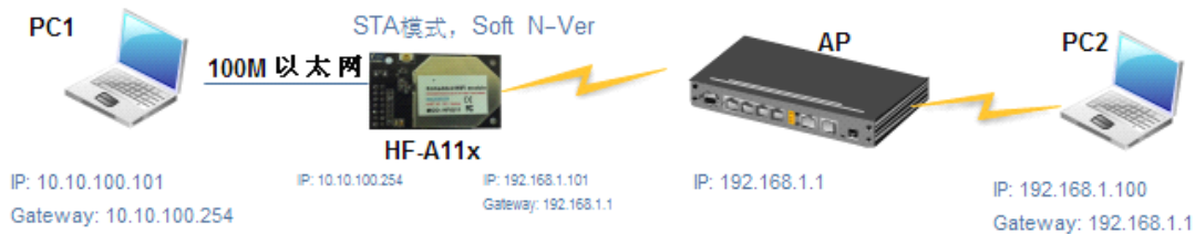
图-19 HF-A11x 以太网接口功能（STA N-Ver）
