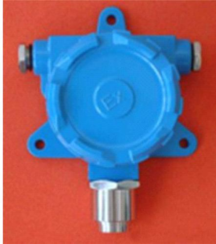
HFTCY-NH3 固定式氨气泄漏检测器主要应用于检测氨气泄漏场所，采用进口电化学式传感器，防爆设计，具有快速、稳定、精度高等优点，防爆接线方式适用于各种危险场所。
