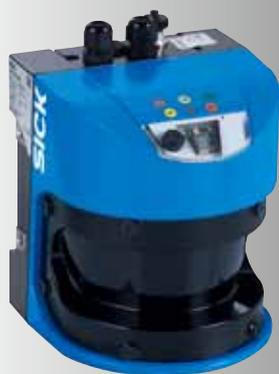
LMS500是SICK新推出的高性能的室内型激光扫描雷达，主要用于室内型的设备防撞，障碍物测量或物体外形测量。LMS500采用成熟的激光-时间飞行原理及多重回波技术，非接触式检测，是室内有效防撞、区域保护、及恶劣环境测量的理想产品。LMS500采用小光点的激光，能够较准确的测量物体的尺寸及距离，是目前高校机器人及室内地图扫描的最佳选择。
