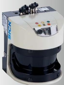
LMS511是SICK新推出的高性能的室外型激光扫描雷达，主要用于室外型的物体测量及防撞。LMS511采用成熟的激光-时间飞行原理及多重回波技术，非接触式检测，是室外防撞、区域保护、及恶劣环境测量的理想产品。LMS511有四种型号，LMS511-2XXX采用小光点的激光，能够较准确的测量物体的尺寸及距离，其主要用于要求测量精度较高，距离较近的应用；LMS511-1XXXX针对10%反射率的物体，距离可以达到40米，主要针对较远距离的测量及防撞应用。
