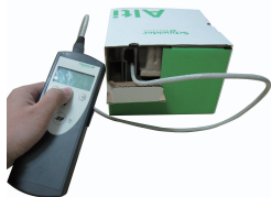
通过多功能下载器及电缆来配置包装内的变频器 VW3A8121+ 电缆套件 VW3A8126
