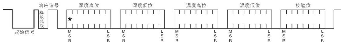
图 5： AM2306 单总线通信协议
