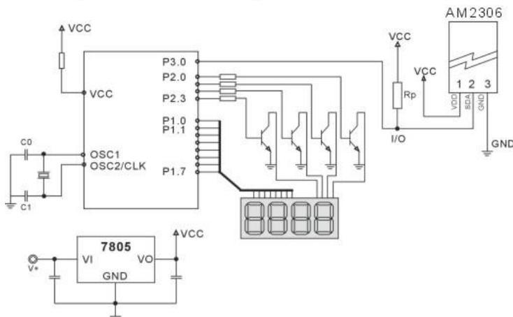
图 4： AM2306 单总线典型电路
