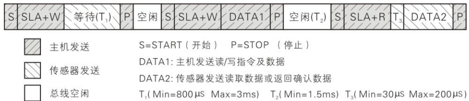
图 13: I 2 C 读写传感器完整示例图
